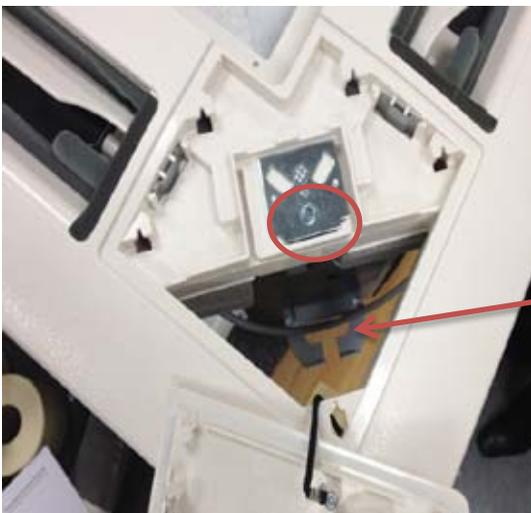
**ATTENTION :** Les panneaux du couvercle de coin peuvent être retirés pour également offrir un accès à la tige filetée.
