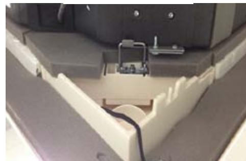
3. Pour enlever la grille d'entrée d'air, dévissez les (2) petites vis de transport sur les onglets de la grille d'entrée d'air, puis rentrez les onglets pour ouvrir la grille d'entrée.
